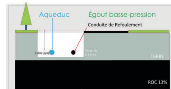
Les conduites d'égout et d'aqueduc peuvent être installées au même niveau, réduisant considérablement les coûts de construction et les risques associés à l'installation de conduites en profondeur.
