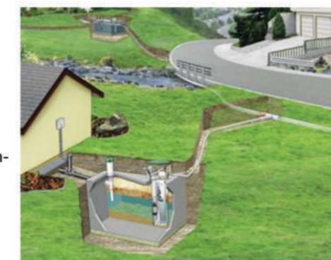
À noter qu'un réseau basse pression ne nécessite pas de champ d'épuration. Chaque résidence sera munie d'une pompe et d'un réservoir; les eaux usées seront donc acheminées directement dans le système d'égout de la Ville.
