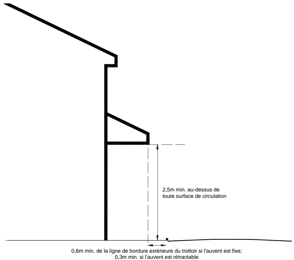
Figure 10-41 Distance minimale entre la projection au sol de l'auvent et la limite de terrain avant et la hauteur libre sous l'auvent
